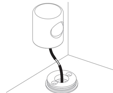
Empalmar el cable de alimentación 12V CA con el artefacto según esquema:
