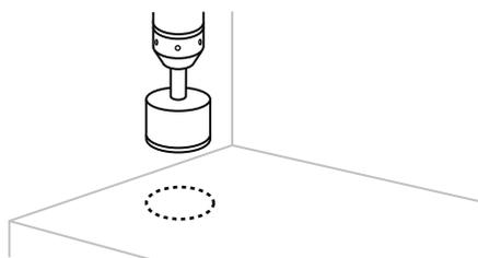
Elegida la posición de la luminaria y previendo la salida de alimentación con un caño corrugado de 5/8, realizar un agujero con una sierra o mecha de copa 17 mm con insertos de Widia.
