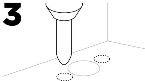
Perforar con una mecha N° 6 con una profundidad mínima de 35 mm.
