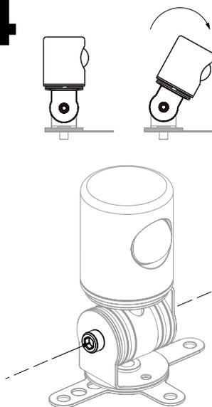
Orientar la luminaria en el sentido de la descarga y fijar con el tornillo allen lateral.
