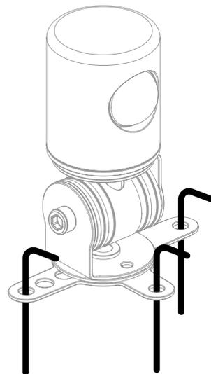
Ubicar la luminaria y cortar el pasto debajo de la base "T" y fijar a través del clavado de las 3 estacas incluidas.
