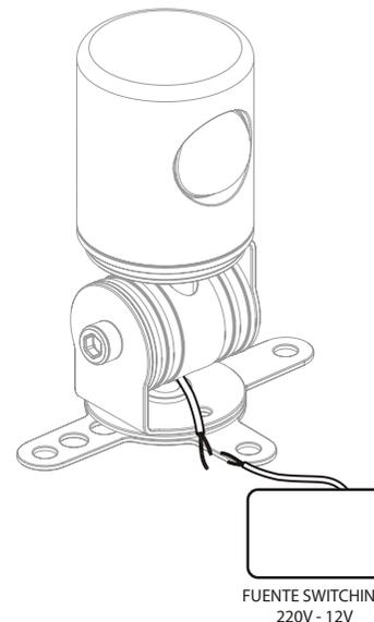
Empalmar el cable de alimentación 12v desde la fuente a la luminaria según el esquema N° 3.
