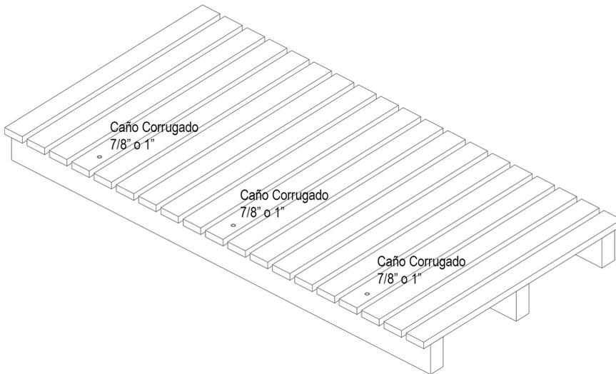
Tener en cuenta que la cañería se coloca desfasada 25mm del eje del artefacto.
