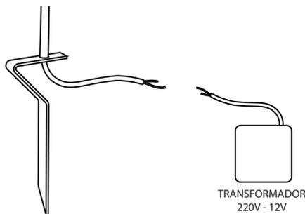
Empalmar el cable de alimentación 12V CA con el artefacto según esquema:
