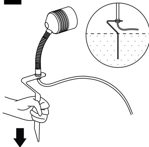
Clavar la estaca, debe enterrarse hasta el plegado, ya que sino podría afectar el correcto funcionamiento de los componentes electrónicos. Orientar el cabezal.
