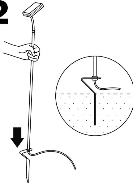
Sostener y clavar la estaca presionado con el pie. Debe enterrarse hasta el plegado, ya que sino podría afectar el correcto funcionamiento de los componentes electrónicos. Orientar el cabezal.
