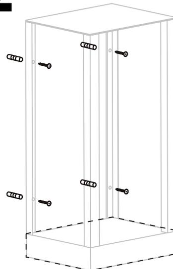
Fijar a la pared con tacos N°6 o N°8 con la caja porta fuente orientada hacia abajo.
