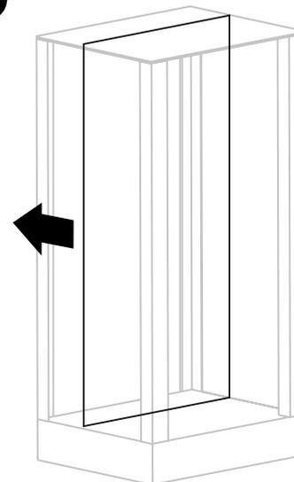
Una vez instalado colocar el fondo magnético ya pintado o tratado en la luminaria para ocultar los agujeros de fijación y la alimentación.
